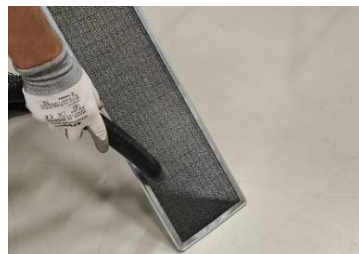
Filter absaugen und nach dem Reinigen wieder einsetzen.
