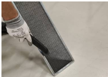
Oczyszczyć filtr i po czyszczeniu ponownie zamontować.
