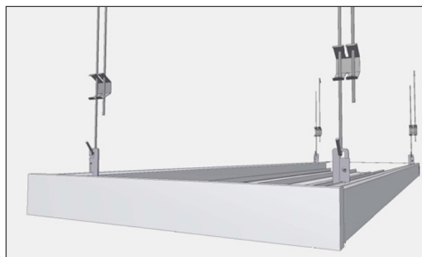
Figur 8. Atrium frihängande med panelhake och justerbara trådpendlar.
